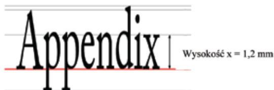
Rys. Minimalna wysokość czcionki Fig. The minimum height of the font
